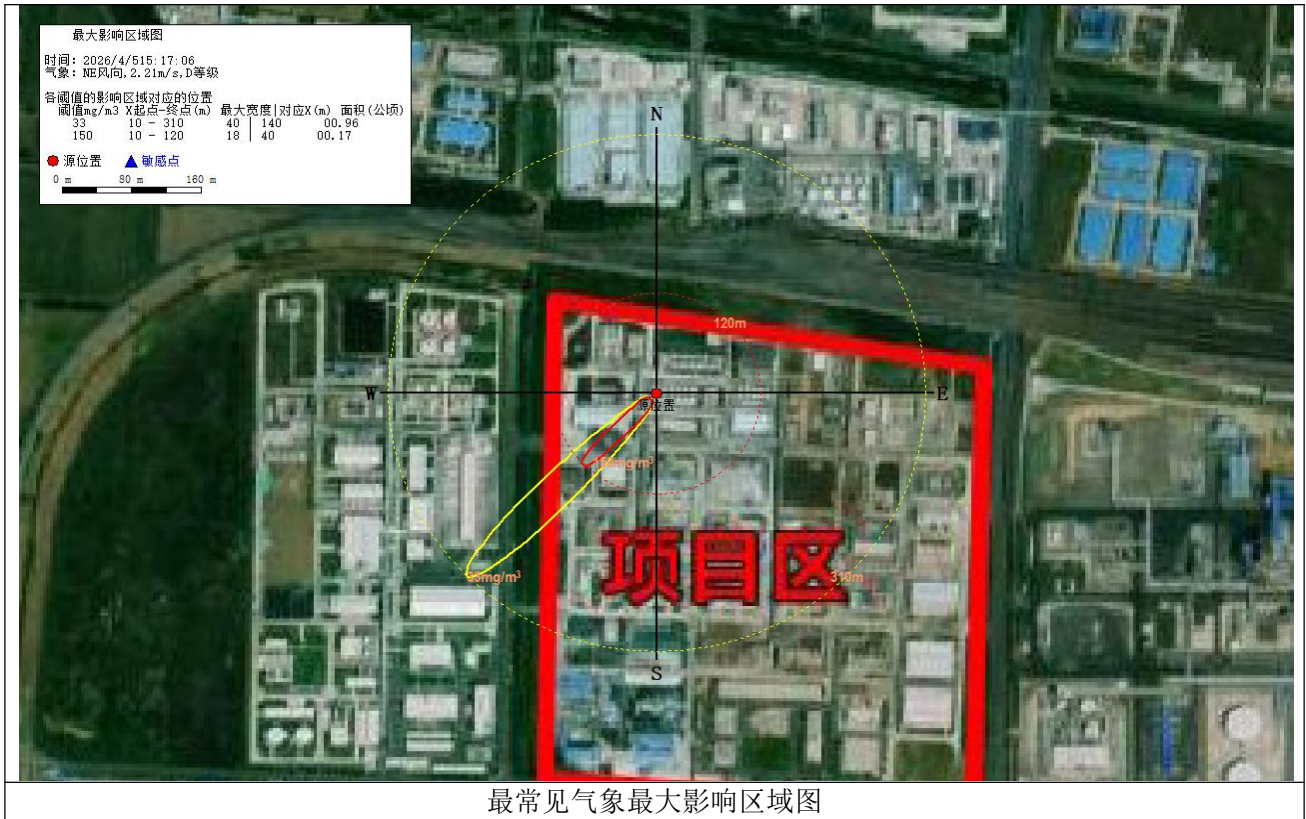
图 6.2.6-6 2-氯-4-氟-5-苯甲酰氯储罐泄漏引发的火灾/爆炸产生次生物质 HCl 预测结果图
